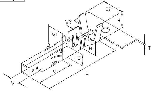
産品編號 Part No: MCN-3101-0024 DIMENSION: (MM) 名 Product: 端子 TERMINAL 品  $T:0.2 \pm 0.03$ 質 Material: Brass/Phos  $L:14.7 \pm 0.3$ 材料厚度Thickness: 0.2mm  $IS:4.0 \pm 0.3$ 包裝數量 Standard Packing: 6000 PCS  $VS:2.3 \pm 0.3$ 適用電線 Suitable Wire: 18~24AWG  $H:3.7 \pm 0.25$  $H1:2.7 \pm 0.25$  $H2:2.05 \pm 0.15$
